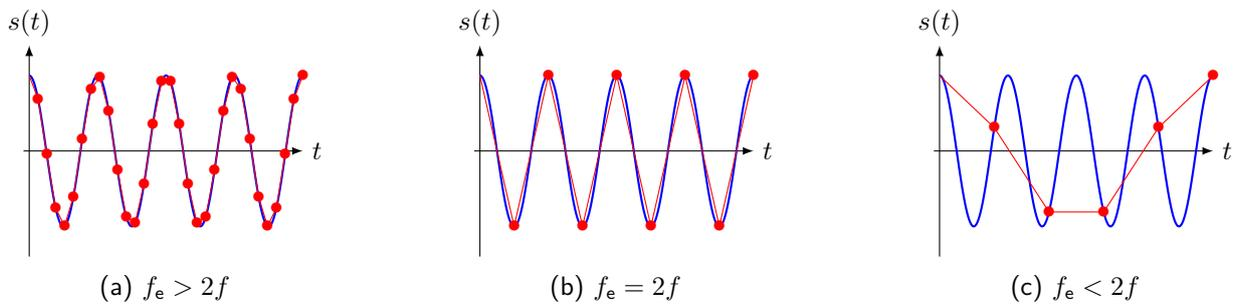
**Fig. 3** – Visualisation du critère de Nyquist-Shannon sur un signal sinusoïdal. Pour une fréquence d'échantillonnage exactement au critère de Nyquist-Shannon, on a un signal triangle variant à la bonne fréquence. Le contenu fréquentiel est différent, mais la fréquence fondamentale est conservée. Par contre, pour une fréquence d'échantillonnage en dessous du critère de Nyquist-Shannon, la fréquence du signal est perdue.
