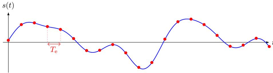
**Fig. 1** – Visualisation de la période d'échantillonnage. Le signal analogique est la fonction continue. Le signal numérique enregistré est constitué de la suite discrète des valeurs de tensions  $\{s_i\}$ , représentée par des points sur le signal. L'écart temporel entre deux points est la période d'échantillonnage.
