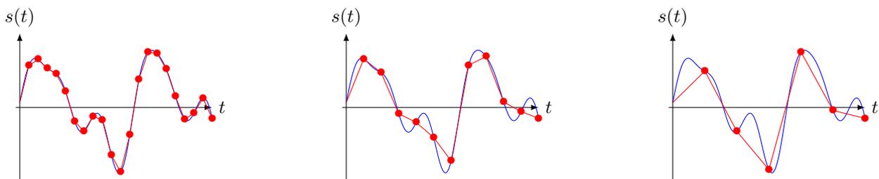
**Fig. 2** – Tracés des signaux numériques issus d'une numérisation du signal analogique de la figure 1 pour plusieurs fréquences d'échantillonnage. On constate que plus la période d'échantillonnage augmente, moins les variations rapides du signal analogiques sont enregistrées dans le signal numérique, et moins la conversion analogique-numérique est fidèle.
